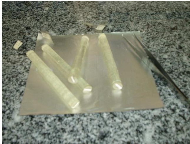
Figura 3.1. Sensor de umidade de solo. Fonte: [12].
